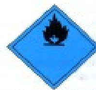
EMANACION DE GAS INFLAMABLE AL CONTACTO CON EL AGUA (Azul-negro)
