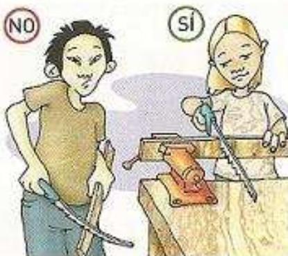
Sujeta las piezas con firmeza mediante tornillos o mordazas.
